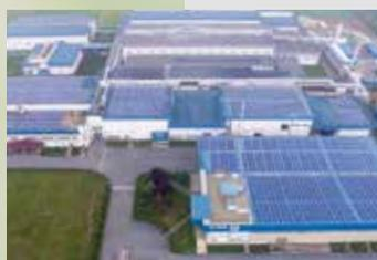
Une installation photovoltaïque a été montée et mise en service sur notre site de production de KST (Chine). Elle produit chaque année plus de 900 000 kWh d'électricité, essentiellement consommée sur place.
